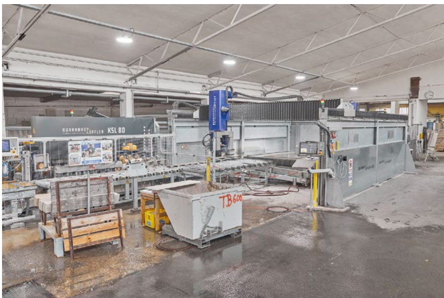
Die vollautomatische Sägestation ist für eine Maximalkapazität von 150-250 m 2 /Tag ausgelegt.
