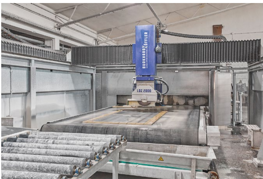
Eine LDZ 2000 mit Vakuumvereinzelung lädt Sägestücke vom Sägeband und zerkleinert Abfallstreifen.
