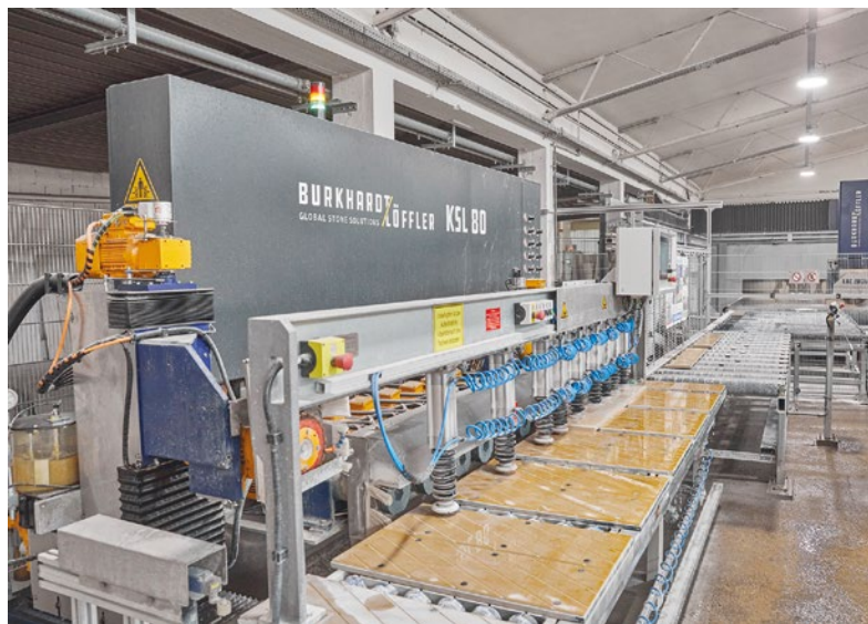
Am Ende der Bahn arbeitet die Kantenschleifmaschine KSL 80 mit acht Stirnflächensupporten sowie je drei Ober- und Unterfasen mit Abtastvorrichtung.
