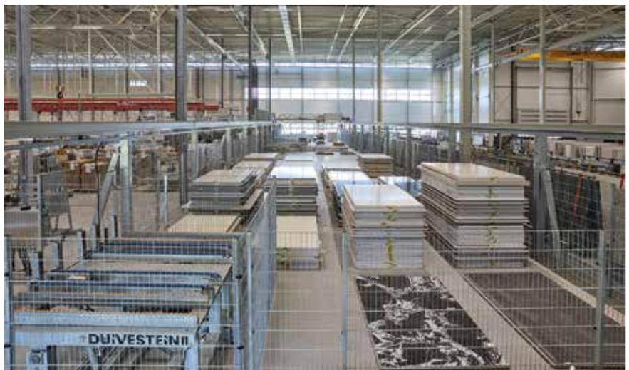
Vollautomatisches Plattenlager in der neuen Werkhalle; alle Platten darin wurden zuvor digital erfasst.
