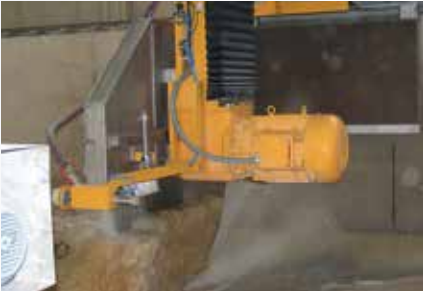
Direkt angetriebene Sägewelle Direct drive of saw shaft
