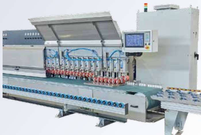
Einzelansteuerbare Andruckrollen Individually controllable pressure rollers
