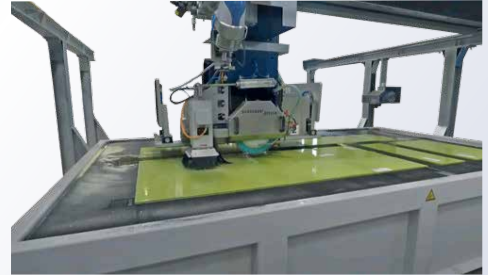
Automatisierung Säge + Wasserstrahl Automated combination of saw + waterjet
