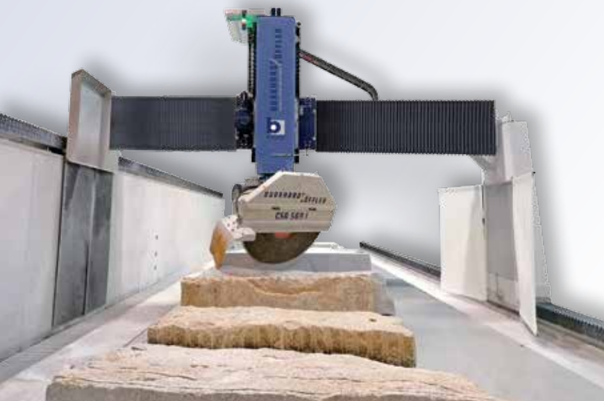
Schwenkeinrichtung für Gehrungsschnitte Tilting saw head for miter cuts
