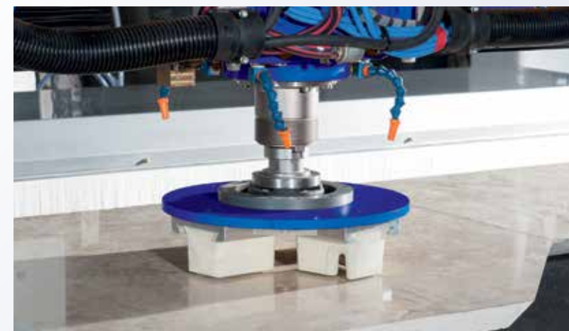
Schleifteller mit „Frankfurter“ Segmenten Grinding plate with Frankfurt-type segments
