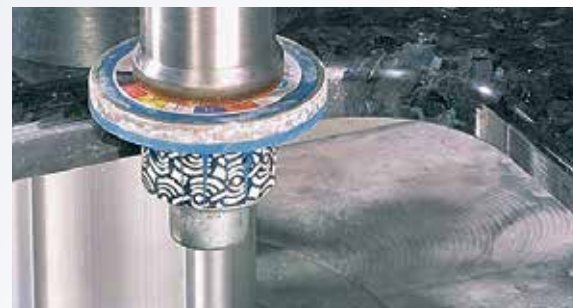
Schleifen und Polieren von Ausschnitten Grinding and polishing of cutouts
