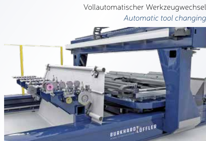
Werkzeugmagazin mit bis zu 60/120 Plätzen Tool magazine with up to 60/120 positions
