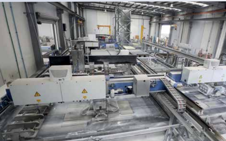
Integrierte Fertigungsanlage für Küchenarbeitsplatten mit Pufferlager Integrated manufacturing facility with buffer storage for kitchen worktops
