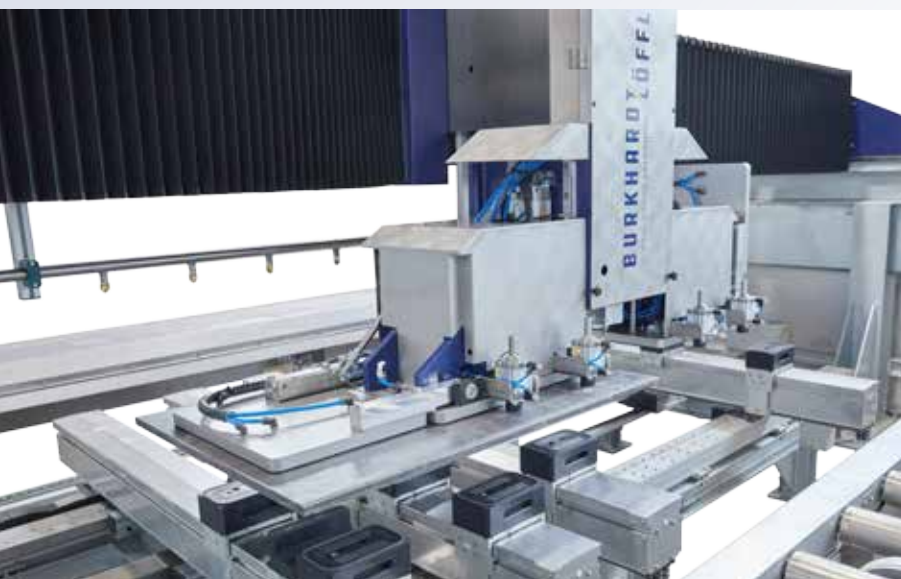
BAZ 2000 mit automatischem Saugersystem BAZ 2000 with fully automatic vacuum pod positioning
