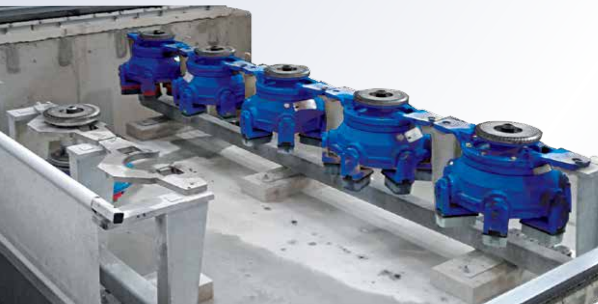
Automatischer Schleifkopfwechsel Automatic changing of grinding heads
