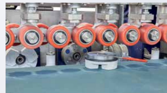
Magnetsystem zum schnellen Schleifscheibenwechsel Magnetic system for quick grinding wheel change
