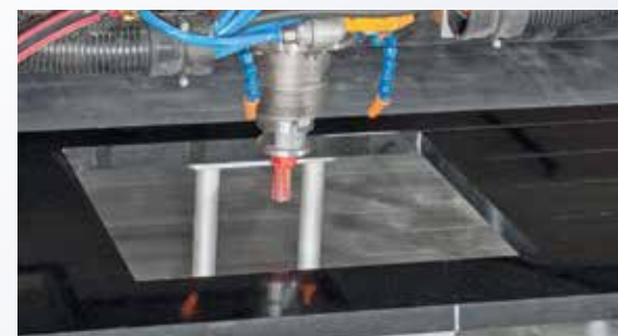
Fräsen von Ausschnitten und Konturen Milling of cutouts and contours
