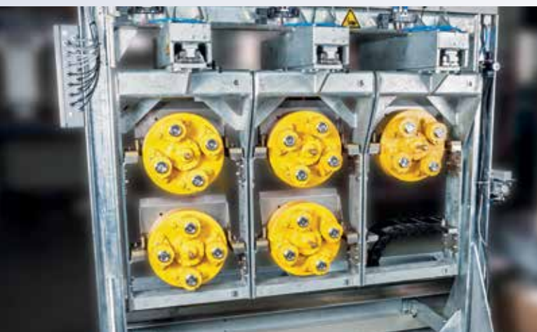
Automatischer Schleifkopfwechsel Automatic changing of grinding heads
