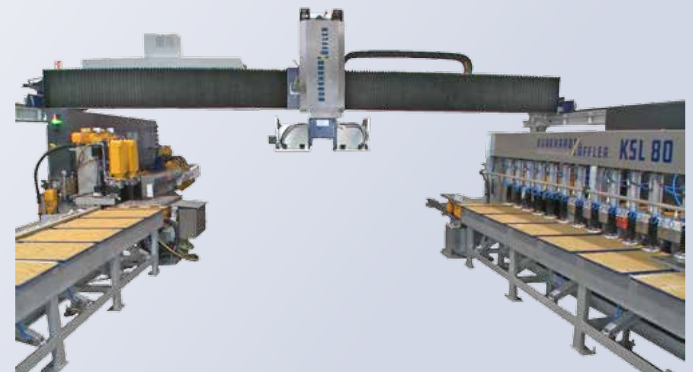
Automatisierung Kantenschleifmaschine Automation of edge polisher
