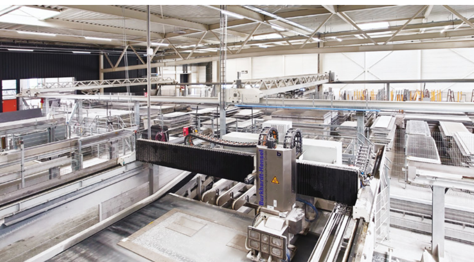
Oben: Durch zwei Auffangbecken ermöglicht die Powerjet 3D Twin die Bestückung und Entladung der Maschine während des Bearbeitungsvorgangs
