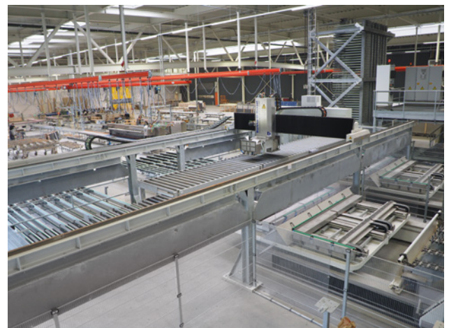
Im vollautomatischen Speicherregal (hinten rechts) zwischengelagerte Werkstücke werden auf der oberen Ebene einer doppelstöckigen Rollbahn den beiden CNC-Bearbeitungszentren zugeführt
