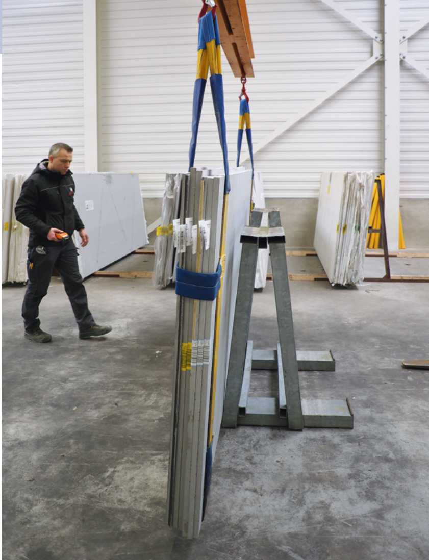
Plattenanlieferung: Die mit Lkw angelieferten Rohplattenbündel werden mit einem Brückenkran entladen
