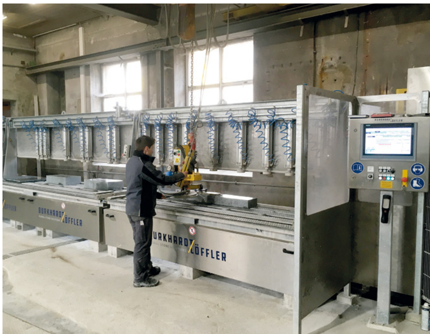
Unterschiedliche Materialstärken in einer Aufspannung: Die Tischmaschine KSA 542 von Burkhardt-Löffler wurde 2020 im Granitwerk Karl Schörner installiert.
