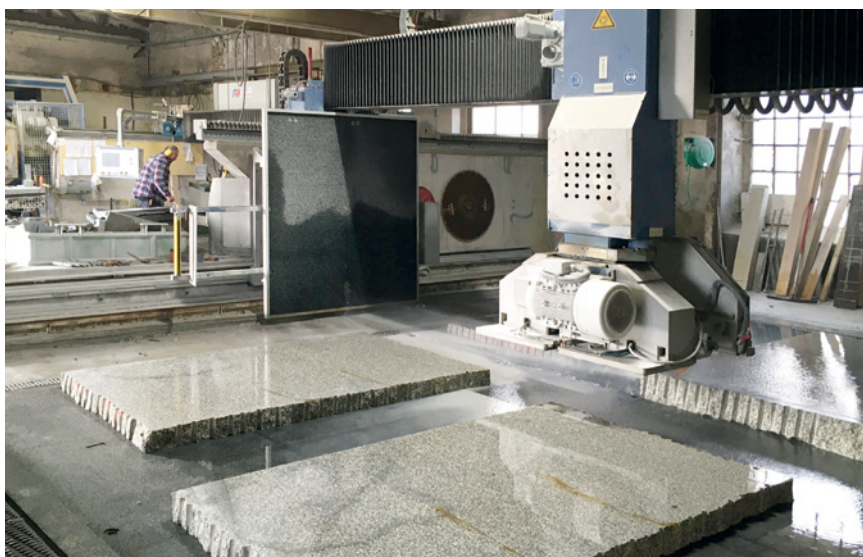
Vollautomatische 5Achsen-Drehkopfsäge Burkhardt-Löffler CSA 567 mit Vakuum-Manipulator, im Hintergrund die Brückensäge Fickert PFE
