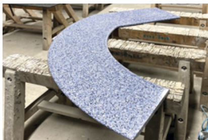
Obwohl Naturstein vorherrscht, werden Aufträge wie dieses komplexe Sonderteil auch in Quarzkomposit ausgeführt. Foto: Thomas Straßner
