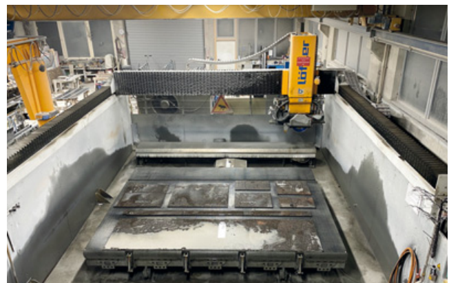
Die Vereinzelung per Vakuum-Aggregat beschleunigt bei mehrteiligen Aufträgen den Sägevorgang. Foto: Thomas Straßner
